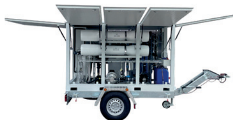
Impianti di trattamento acque su ruote
