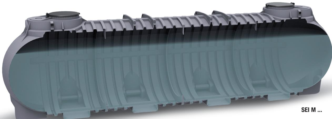
Fornitura di serbatoio in polietilene modulare da interro per lo stoccaggio di acqua o liquidi in genere compatibili con il Polietilene ad alta densità, composto da moduli a spessore costante delle pareti (10/12 mm) uniti tramite elettrosaldatura che assicura una perfetta tenuta idraulica e meccanica.
